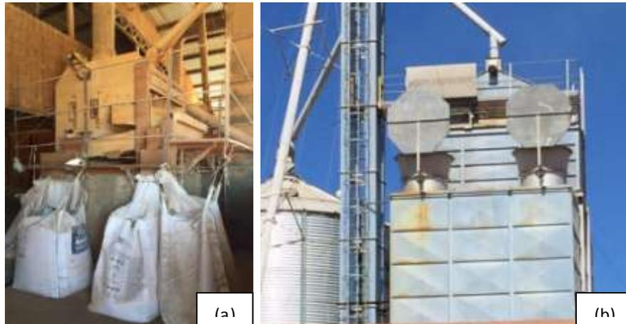
**Figura 4:** Pré-limpeza dos grãos: (a) segregação e impurezas por peneiramento e (b) correção do teor de umidade no secador de grãos
